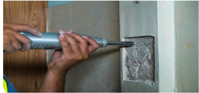
Figure-6. Schmidt Rebound Hammer.
